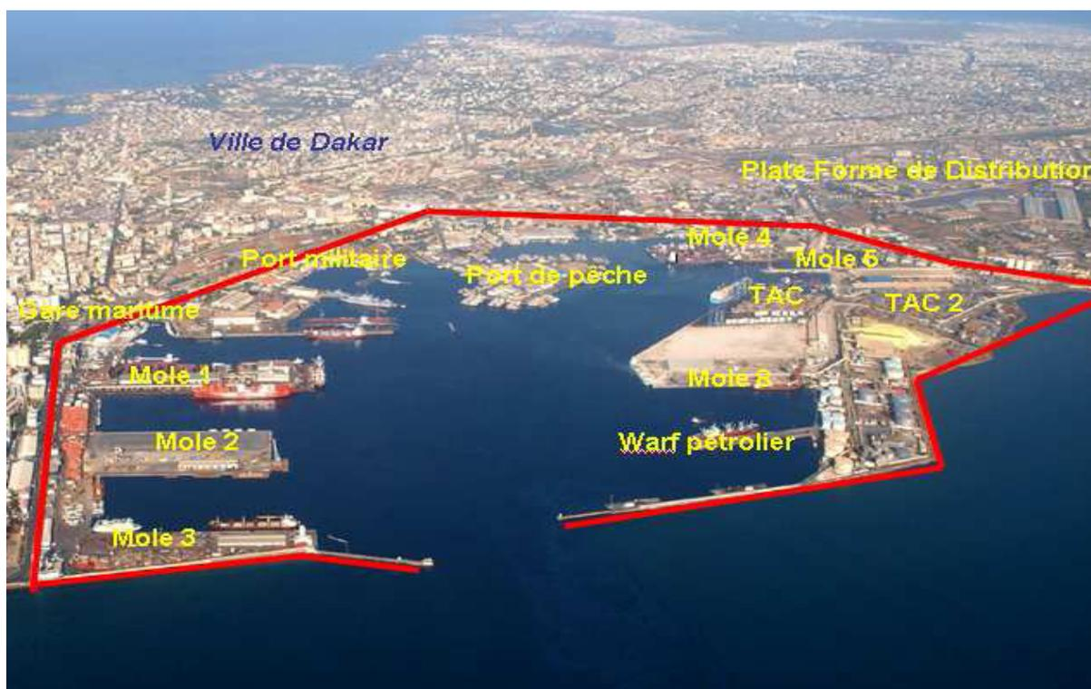
Port de Dakar : L'extension du terminal à conteneurs (TAC - remblaiement entre le TAC et le môle 8) dont le quai fondé à 13m permettra de recevoir des navires porte-conteneurs de troisième génération (source : diagnostic national)
